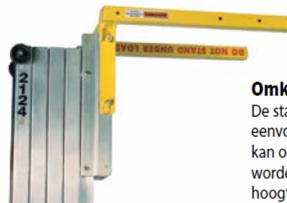
Lasthaak (783642) De haak heeft 5 posities, met een respectievelijke laadcapaciteit van 300kg, 240kg, 195kg, 135kg en 90kg.
