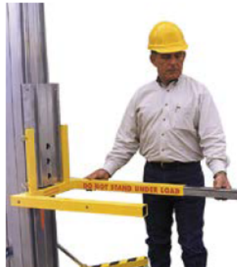
Vorkverlengset (783691) Met een druk op de knop worden de vorken verlengd van 71cm naar 106 cm Let op: met het verlengen van de vorken zal de capaciteit verminderen (300kg – 90kg).
